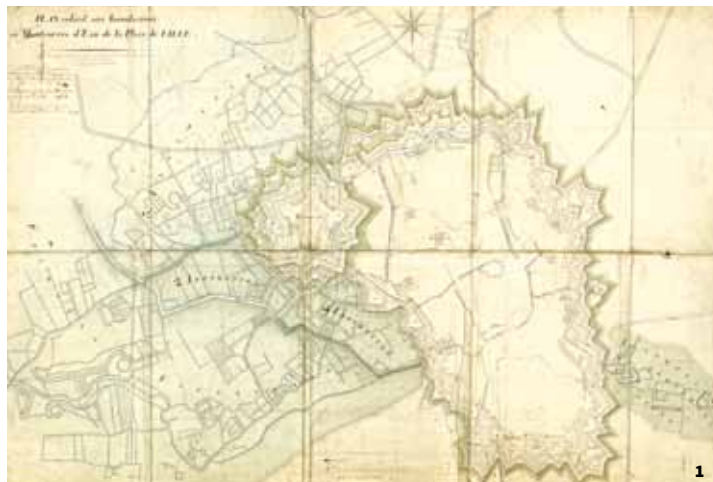
1. Plan relatif aux inondations et manœuvres d'eau de la place de Lille Début du XIX e siècle
